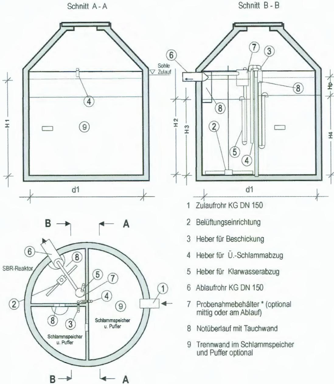
\*Je nach Ausführung mit Tauchwand oder Tauchrohr lt. Anhang
